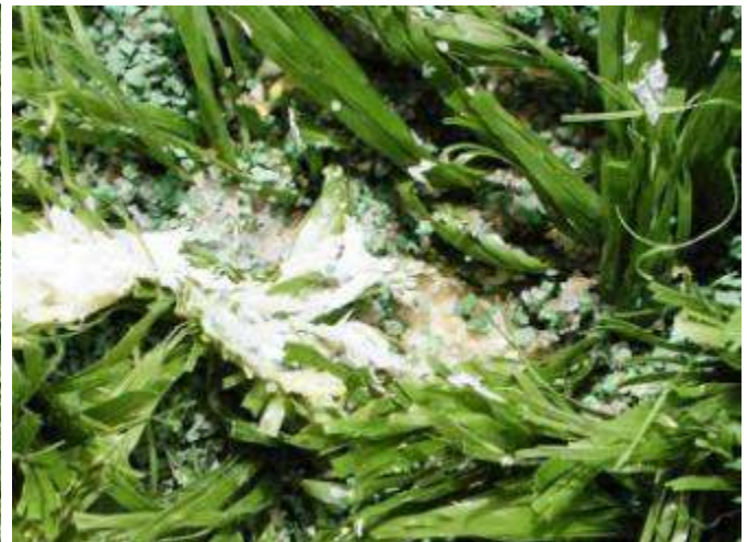
Nicht annehmbarer harter Kleber auf der Oberseite und innerhalb der Rasenfasern
