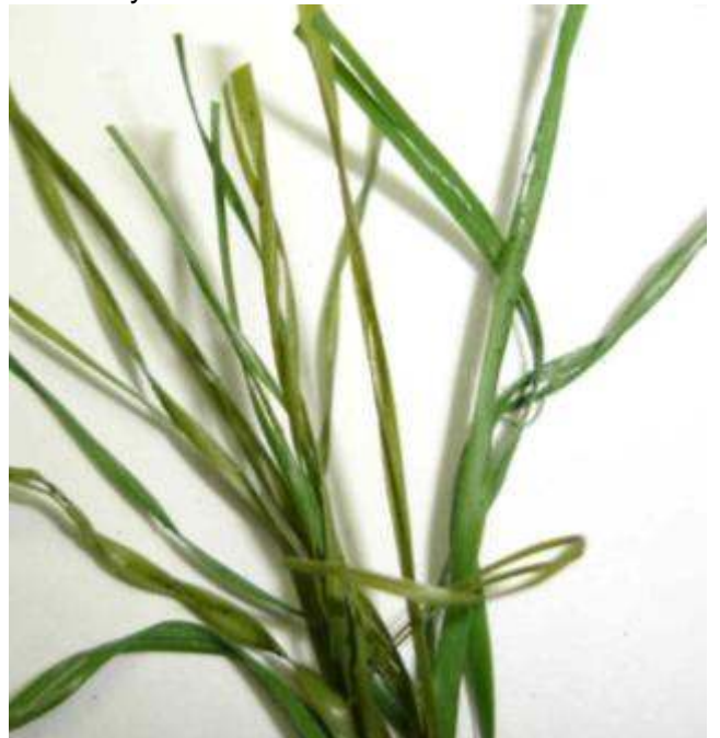
Gebrochene Fasern nach 15'000 Zyklen
