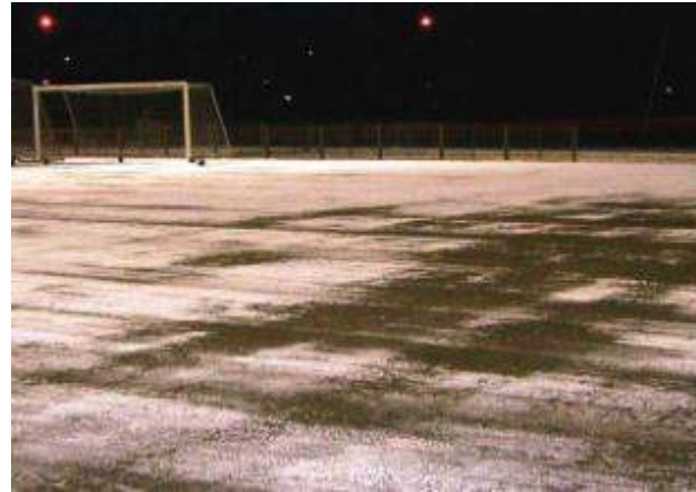
Schneeräumung mit Fräse, anschliessend Schneeschmelzen durch die Bodenheizung
