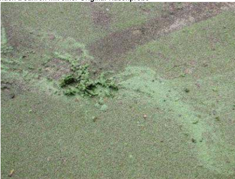
Resultat der Abnutzung einer schwachen Rasenfaser: Die Fasern sind nur noch kleinste Teile, welche zusammen kleben.
