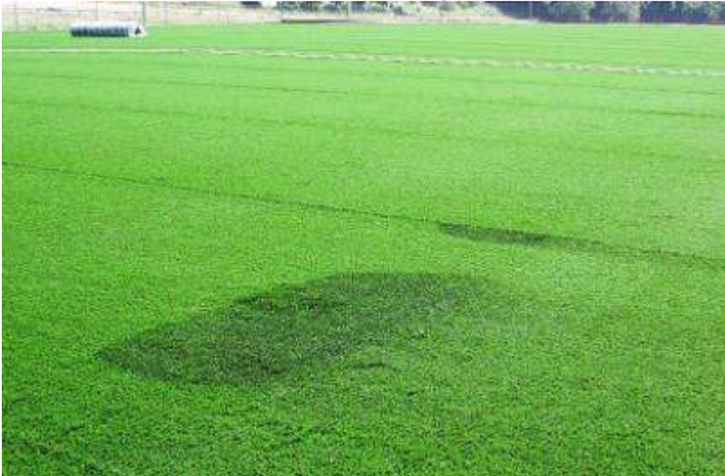
Verbrannte Fasern, entstanden beim Trocknen des Rasenrückens
