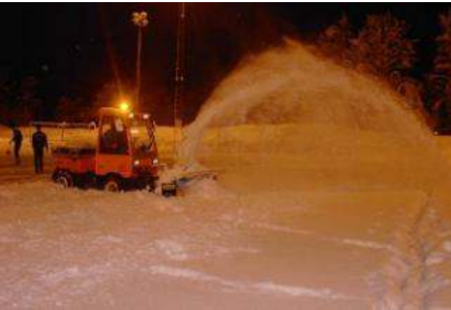
Schneeräumung mit Fräse, anschliessend Schneeschmelzen durch die Bodenheizung
