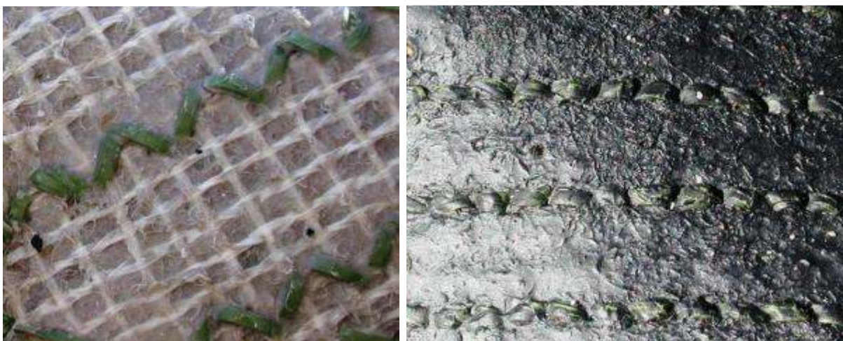
Unterschiedliche Arten von Rasenrücken und verschiedene Methoden des Tuftens (Durchstechen) der Fasern in den Rücken
