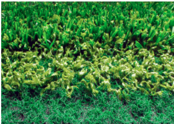
Aufnahme eines unverfüllten Football Turf mit unterschiedlichen Fasern innerhalb eines Systems
