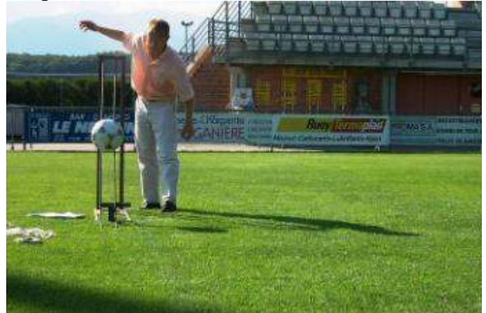
Ballrollverhalten; Messung der Rolldistanz
