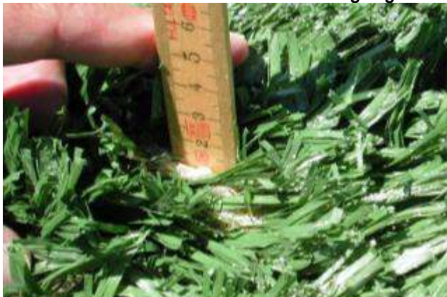
...dies führte zu unterschiedlichen Einbaustärken, welche schwierig zu kontrollieren waren. Oft wurde zu viel verfüllt, und viele Fasern blieben unter der Verfüllung begraben.
