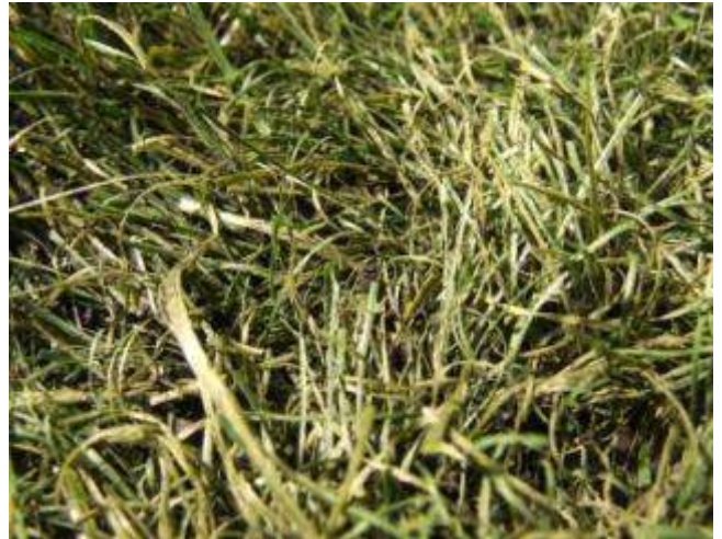
Abgenutzte und gebrochene Fasern, bereits nach 10'000 Zyklen
